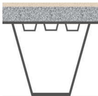
图 2 钢—混组合钢箱梁示意图
