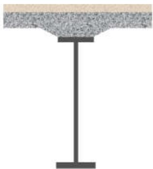
图 1 钢板组合梁桥示意
