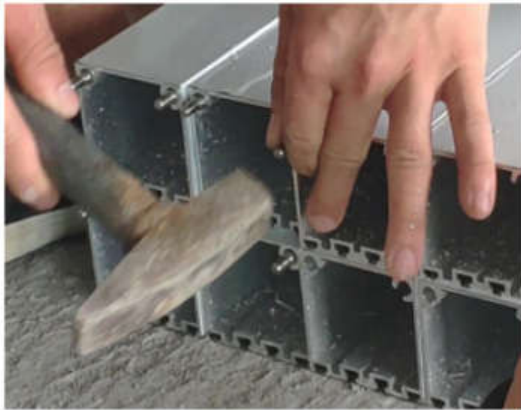
图2 安装弹簧钢销
