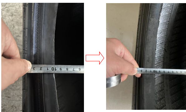
图 5 改进前后的轮胎密封唇口尺寸对比
