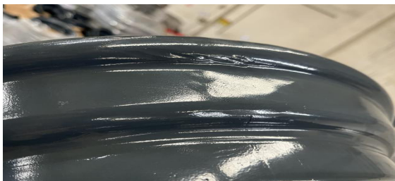
图2 轮辋制造缺陷
