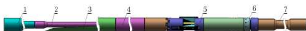
1- 送入工具; 2- 注水泥插管; 3- 斜向器; 4- 调整短节; 5- 裸眼锚定器; 6- 破裂盘接头; 7- 尾管
