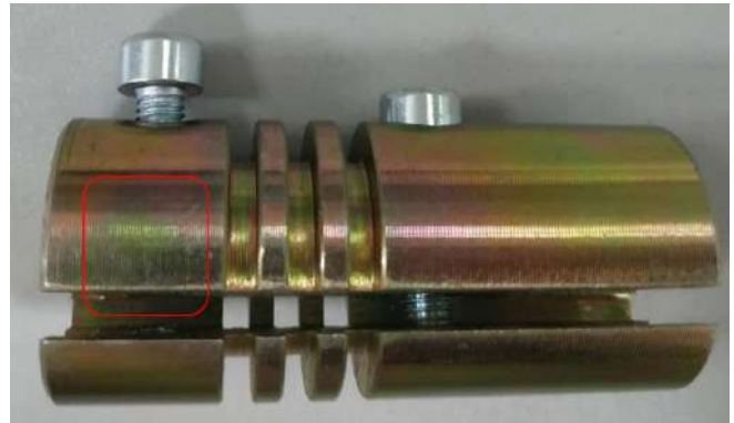
图5 左侧螺栓无法旋入，连接轴内螺纹损坏
