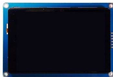
图 3 2.8 寸 vlcds HMI 电容触摸屏外观图
