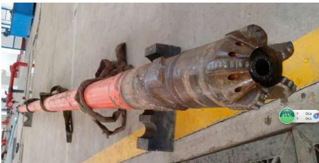
图 5 铝合金内筒配合液力加压取心工具进行室内试验
