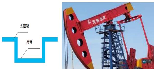
图7 抽油机吊环(臂)示意图及实际安装图
