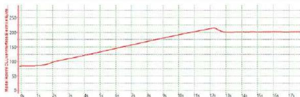
图 11 非分布式驱动电机扭矩输出和转向半径曲线
