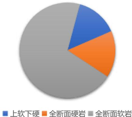
图1 隧道区间左线岩层分布统计图
