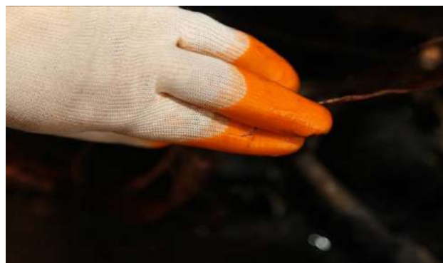
图10 2号电动自行车断裂导线处熔痕
