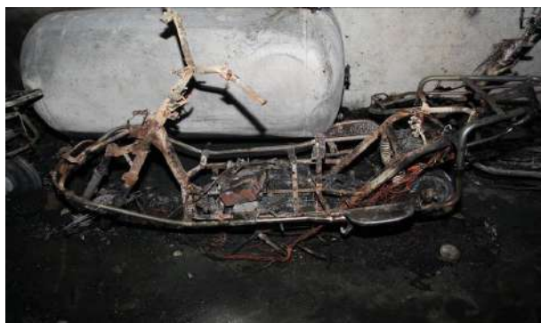
图8 2号电动自行车烧损情况
