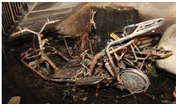
图7 4号电动自行车烧损情况
