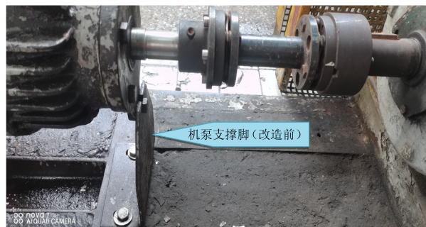
图 2 机泵支撑脚（改造前）
