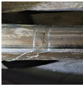
图6 岔趾(岔跟)轨头表面伤损
