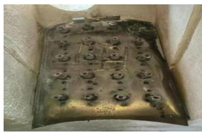
图 2 技改后的流化板实物图
