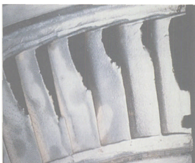
图1 汽轮机叶片的冲蚀状况
