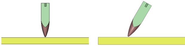
图 1 37mm 尖头穿甲弹侵彻 30mm 厚均质靶板
