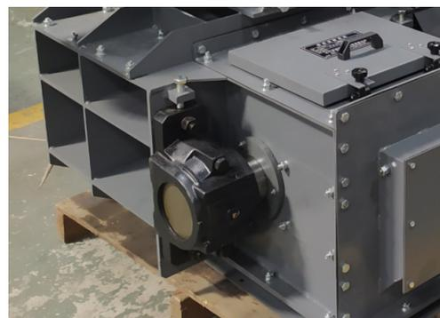
图 5 埋刮板输送机轴密封结构示意图及实物照片
