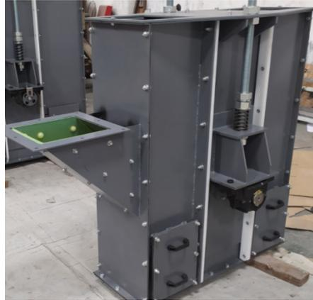
图6 提升机尾部张紧位置密封结构示意图及实物照片
