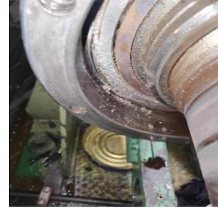
图9 轴承保持架磨损检修效果图
