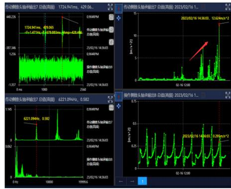
图 3 轴承输出 7 和操作侧锥头轴承输出 8 多参量
