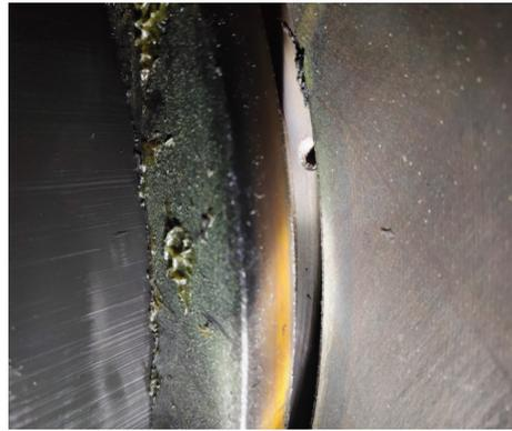
图 4 检修效果图（定位套脱出）
