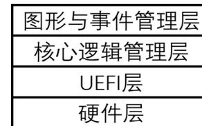
图 1 系统整体架构
