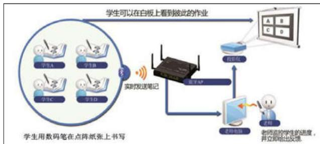
图6 点阵笔的基本信息传导流程图
