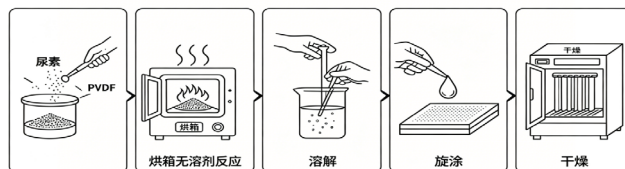
图 1 CD@PVDF 复合材料的制备与薄膜成型过程示意图
