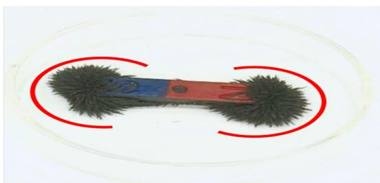
图1 铁粉在磁铁两极呈弧形分布
