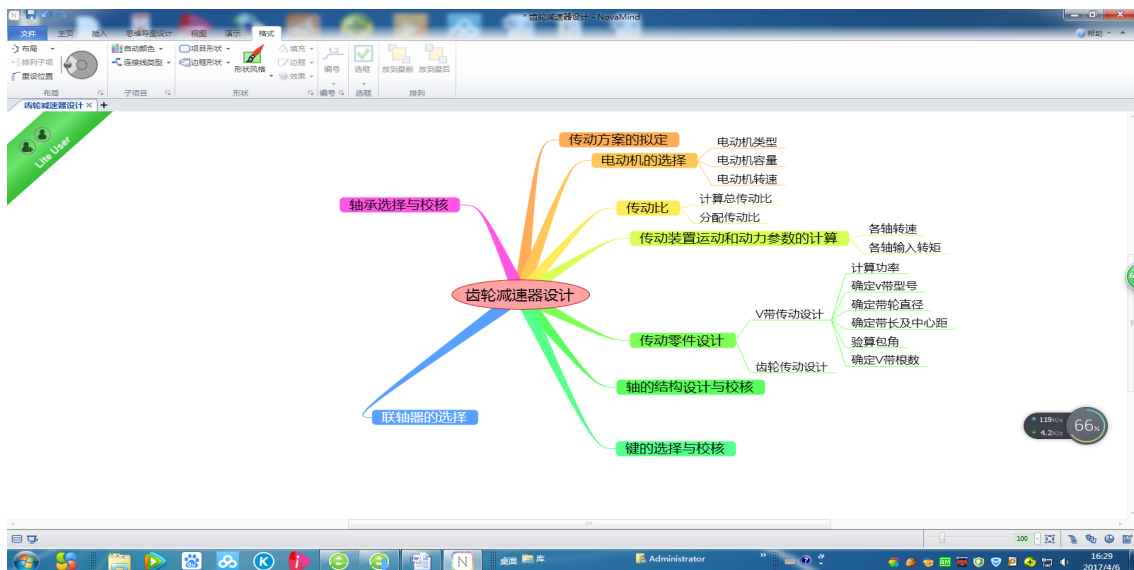
图 2 单级齿轮减速器的设计过程思维导图
