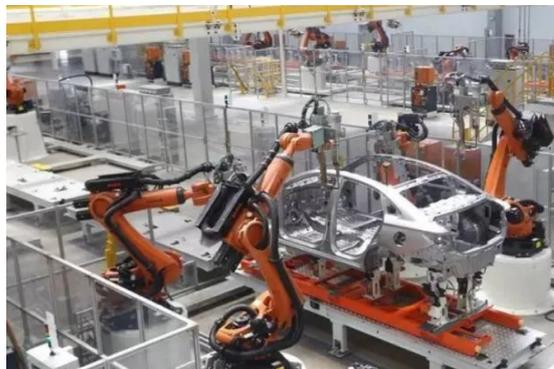
图2：汽车焊装车间实拍图
