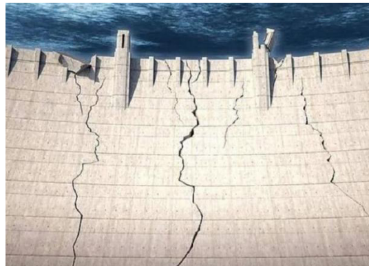
图2 大坝混凝土裂缝示意图
