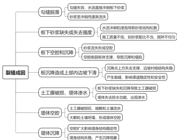
图1 渠道裂缝的产生原因
