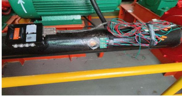
图4 应变片粘贴示意图
