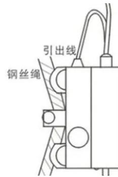
图 3 钢丝绳压力传感器安装示意图
