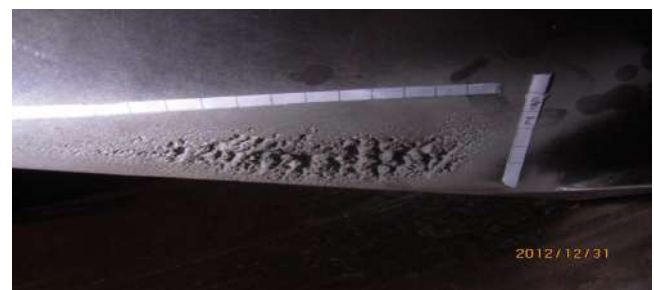
图2 2012年12月戈枕2号机组4#桨叶气蚀情况
