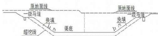
图2 水利施工换填土技术示意图
