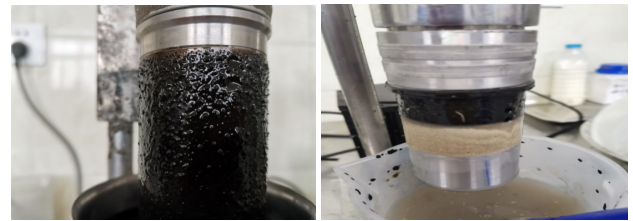
图2 冲洗泥饼前后对比
