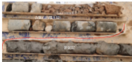
图1 ①层淤泥及上部填土
