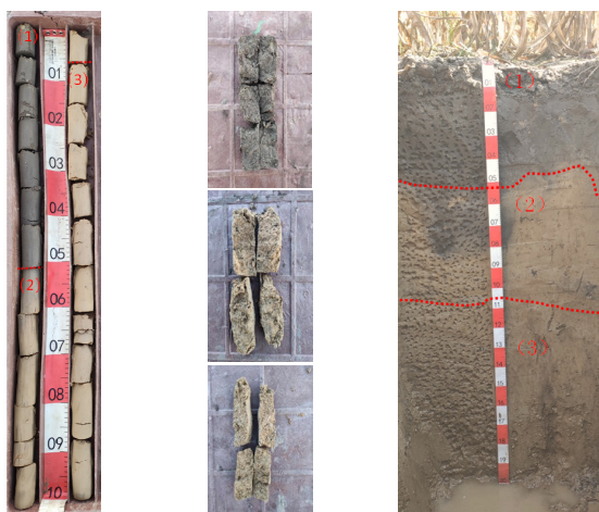
a) 洛阳铲调查 b) 土芯内部结构 c) 人工剖面
