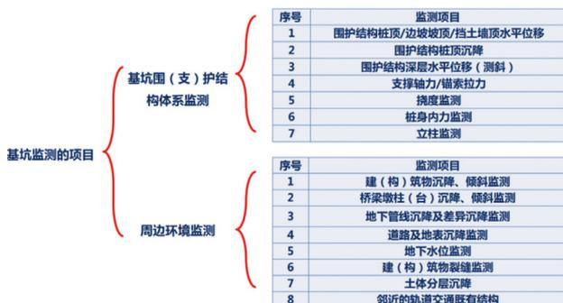
图 1 深基坑监测的项目
