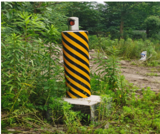
图1 现场实际基准点
