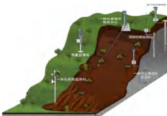
图1 智能山体滑坡监测体系的构成
