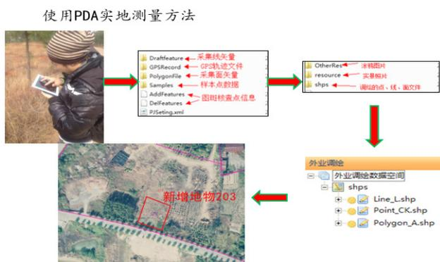
图2 平板外业核查流程
