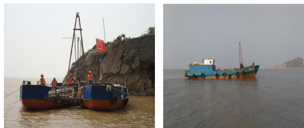
图1 双体钻探船和单体钻探船实景图
