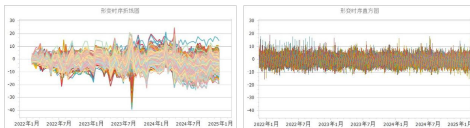
图4 矿区形变时序折线图与直方图
