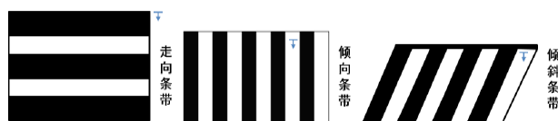
图 2.3 条带开采布置方式
