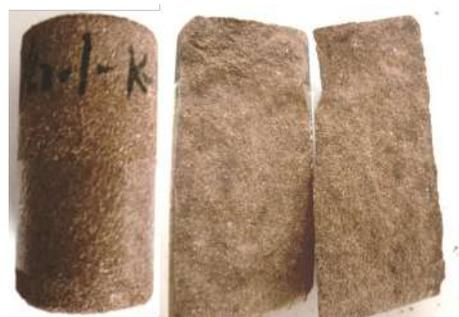
图3 岩心线切割造缝端面形貌
