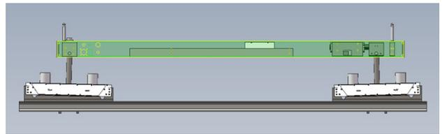
图1 承轨台测量电子尺
