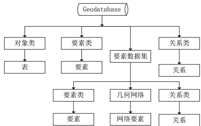
图 1 Geodatabase 的数据组织结构
