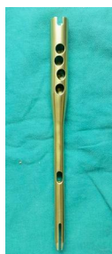
图2 股骨近端髓内钉侧面观，近端有4个滑动孔，可容纳空心拉力螺钉并允许其滑动，自下而上标记为1号2号3号4号（位于人体内时）
