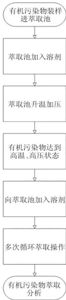
图2 快速溶剂萃取技术的应用流程
