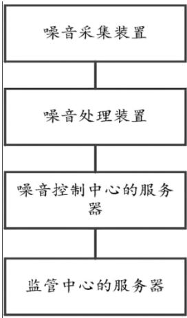
图 2 实时噪声监测系统结构图
