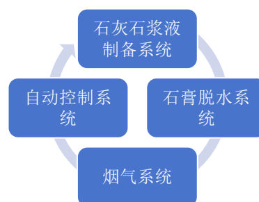
图2：石灰石石膏系统建设要点
